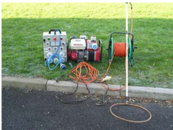
ภาพที่ 3 อุปกรณ์จับปลาด้วยไฟฟ้าแบบติดตั้งริมฝั่งและแบบสะพายหลัง
