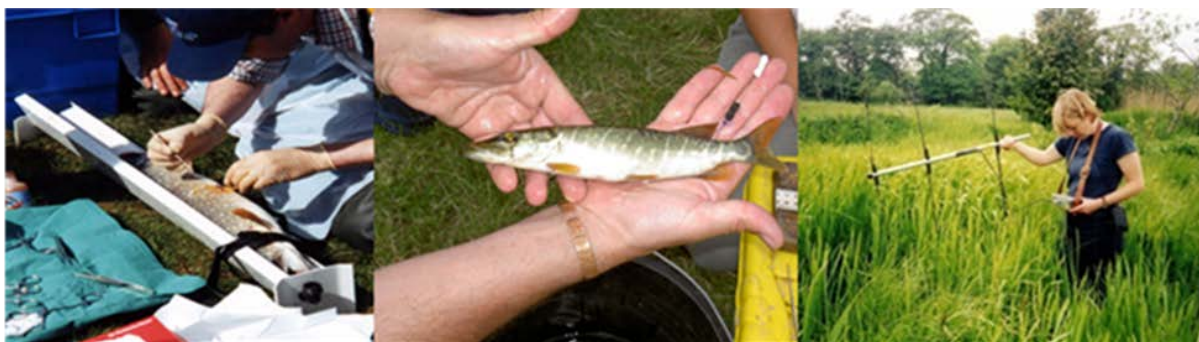
ภาพที่ 4 การใส่แถบรหัสคลื่นวิทยุเข้าไปในช่องของตัวปลา (ซ้าย) แถบคลื่นวิทยุที่มีเสอากาศภายนอก (กลาง) และอุปกรณ์เสอากาศแบบมือถือที่ใช้ในการตรวจจับสัญญาณ (ขวา)
