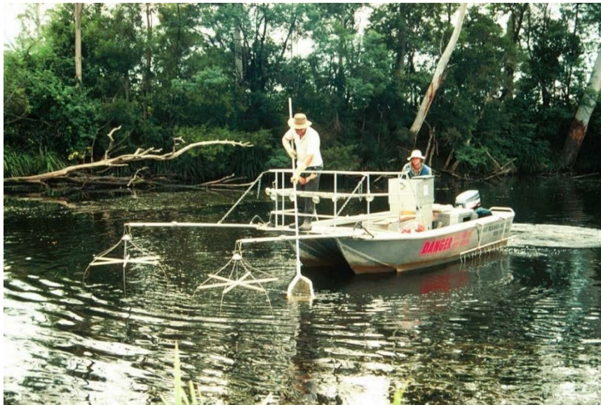
ภาพที่ 2 อุปกรณ์ประเภทเรือจับปลาด้วยไฟฟ้า (ภาพถ่ายโดย: M. Mallen-Cooper)
