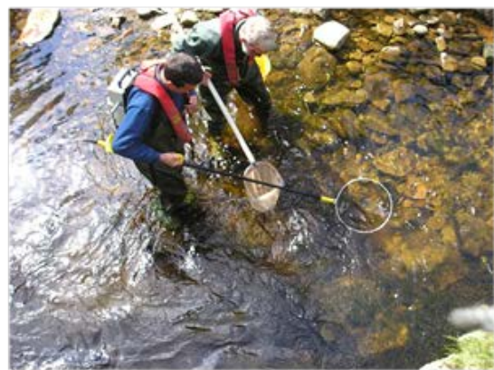
ภาพที่ 3 อุปกรณ์จับปลาด้วยไฟฟ้าแบบติดตั้งริมฝั่งและแบบสะพายหลัง
